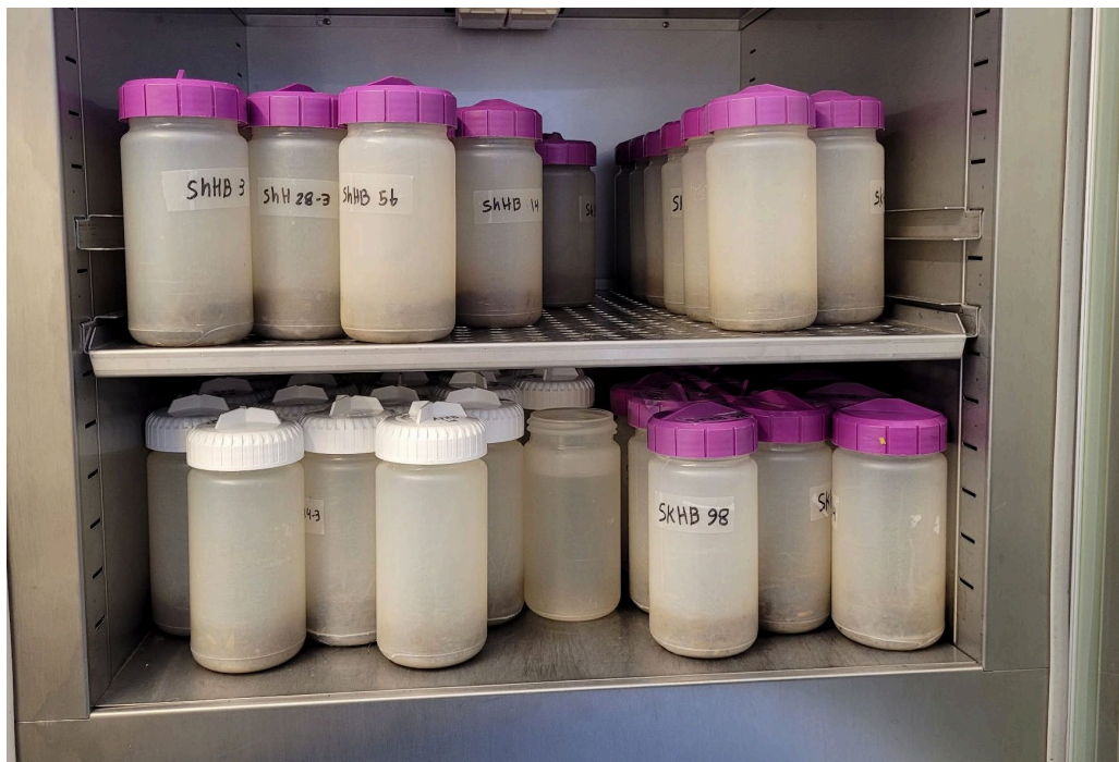
Figur 9: Jord og halm med tilsatt klopyralid ble inkubert ved 20 °C i inntil 98 dager for å undersøke den mikrobielle nedbrytingshastigheten av klopyralid i jorda (Foto: Kathinka Lang, NIBIO).
