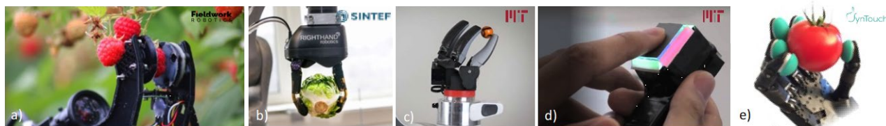
Figur 3. Sansing av interaksjon: Å forstå interaksjonen gjennom taktil tilbakemelding er avgjørende for å sikre en varsom berøring. Matvarer krever høy grad av følsomhet for å bevare kvalitet og holdbarhet. Figuren ovenfor viser eksempler på griper med taktil sansing. Flere slike sensorer er tilgjengelige for forskningsformål, men brukes sjelden kommersielt i matindustrien. (a) Griper utviklet av Fieldwork Robotics og University of Plymouth, (b) griper fra RightHand Robotics – testet hos SINTEF på håndtering av matvarer, (c) nyutviklet griper fra MIT med visuell sensor, (d) GelSight, utviklet av MIT, fungerer som en kombinert visuell og taktil sensor, og (e) trykkfølsomme gelputer som gjør det mulig å delvis registrere kontaktpunktet mellom sensoren og objektet.
