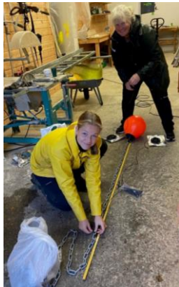
Bilde 1. Festing av sensorer til kjetting for temperaturregistreringer på 0,5 og 1 meters dyp. Foto NORSØK
