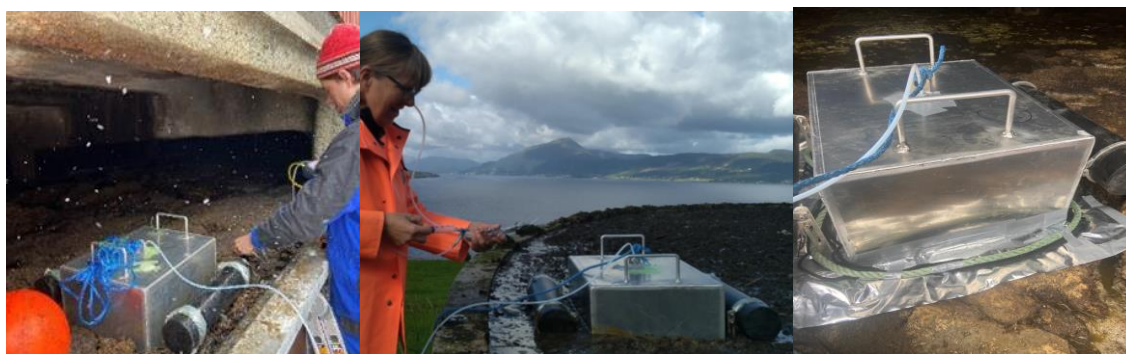
Bilde: Uttak av gassprøver ved hjelp av kammer på gjødsellager. I de to bildene til venstre så har kammeret skjært gjennom overflaten, mens kammeret til høyre hviler oppå gjødselskorpa og har ei kappe rundt for å hindre gassdiffusjon. Foto: NORSØK
