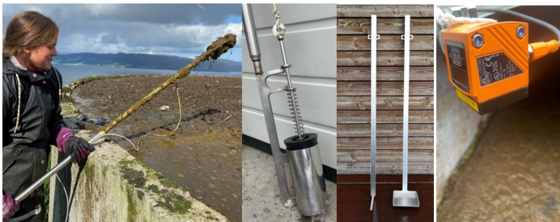
Bilde 3. Fra venstre: gjødselprøvetaker i bruk og i nærbilde, målestav til å bestemme skorpe tykkelse, skorpespade, laser for å bestemme avstand til gjødseloverflate. Foto NORSØK
