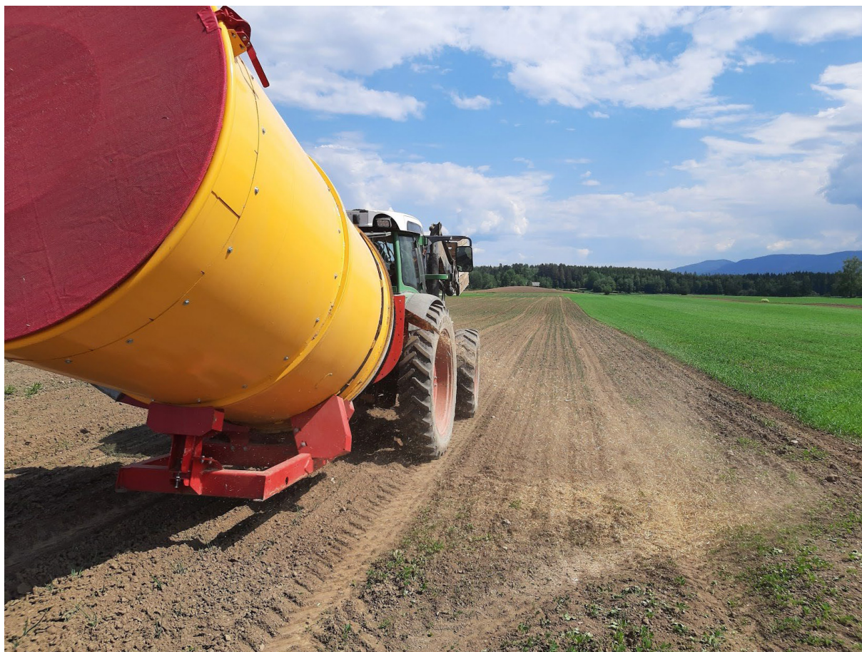
Figur 6.4 Halmtrommel som brukes for å kutte og spre halm i husdyrrom ble prøvd for å spre plante hakk. Det er usikkert at denne kan brukes på silo. Foto: K.Bysveen, NLR
